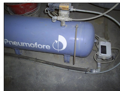
Fig. 4 - Scaricatore di condensa
