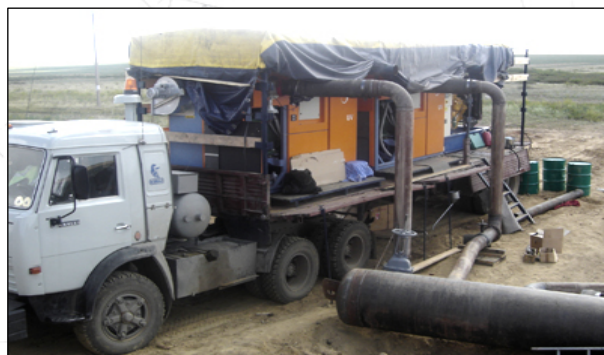
Автоприцеп с дизельной электростанцией и насосами UV
