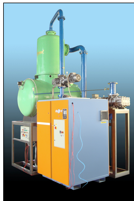
UV8 и 2 насоса Рутса: 3-ступенчатая вакуумная система для сушки
