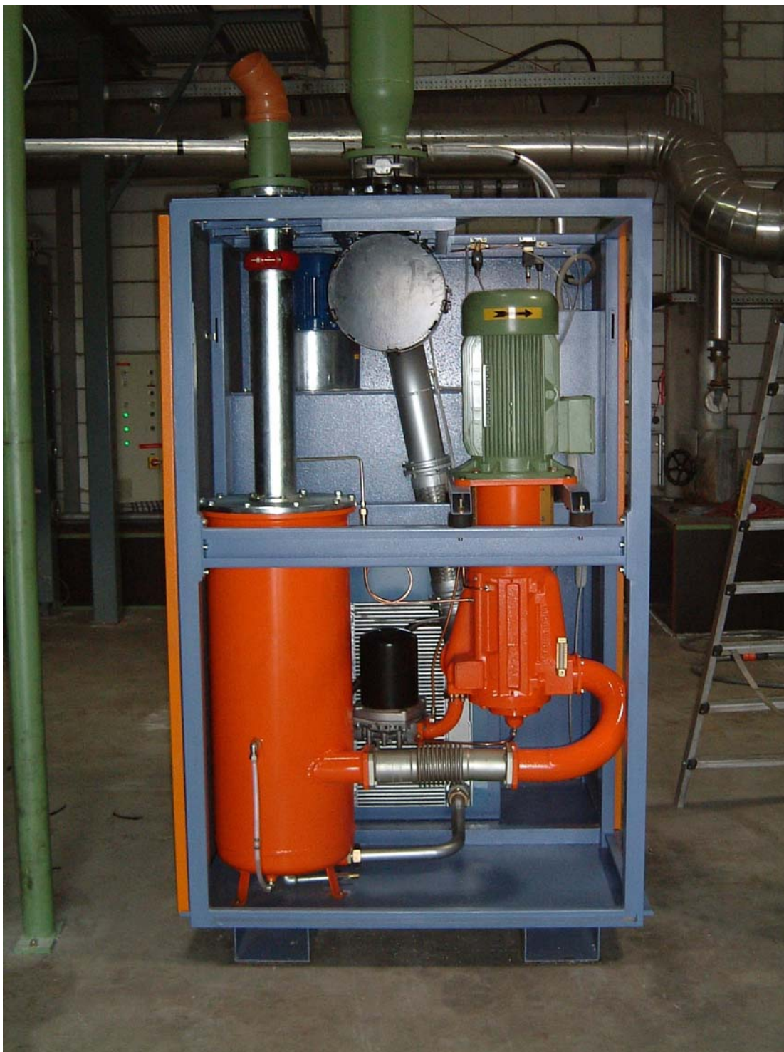
Ansicht Pneumforepumpe und Oelbehälter (rot)
