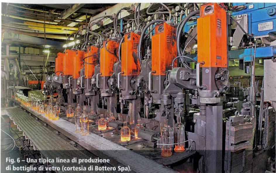
Fig. 6 – Una tipica linea di produzione di bottiglie di vetro (cortesia di Bottero Spa).
