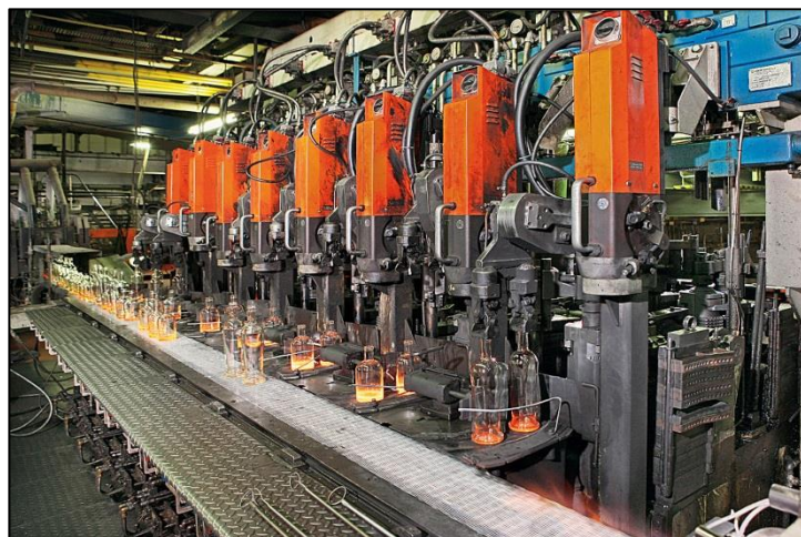
Рисунок 3. Стеклоформирующая машина в процессе производства различных контейнеров (фотография из архива компании Bottero S.p.A.)
