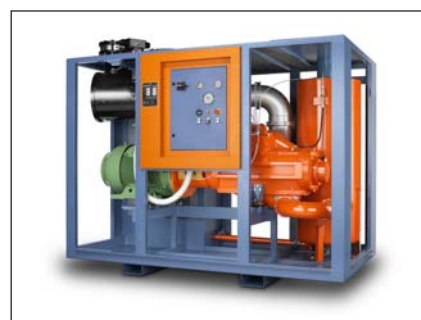
Fig.1 - Pompa per vuoto rotativa a palette UV50, 2.700 m 3 /h, 75 kW, 50 Hz, 1 - 0,5 mbar(a), singolo stadio
