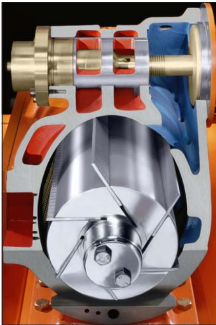
Fig. 5 - Sezione del compressore UR26; è visibile il sistema d'iniezione intensiva
