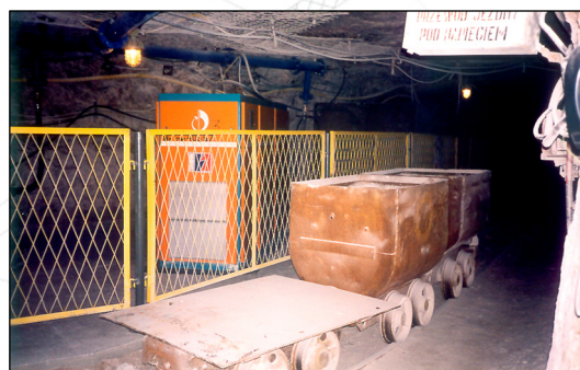
Компрессоры модели AS75/V в шахте Клодава установлены 700 м ниже уровня земли, работают на давлении 5,2 бар(о) с 2002 г
