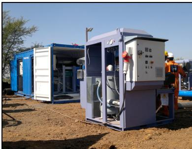
El método de secado bajo vacío se aplicó después de la deshidratación con los “pigs”. El volumen considerable de 102.000 m<sup>3</sup> fue evacuado hasta los 0,3 mbar(a) [29,905 in Hg (V)], que corresponde a un Punto de Rocío de -32°C [-25,6°F] en sólo 6 días.
