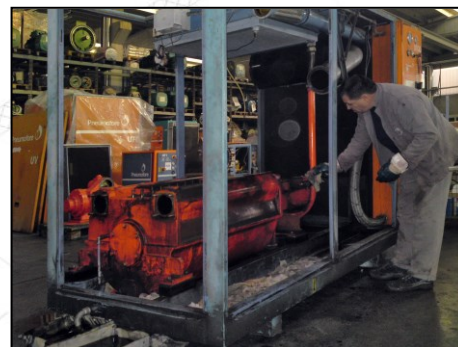
Demontage und Reinigung der UV30
