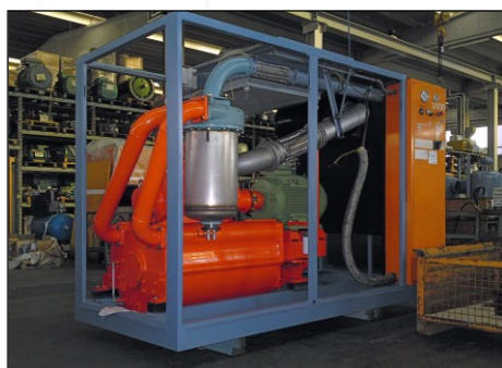
Wieder zusammengesetzte UV30, vollständig überarbeitet, bereit zum Testen
