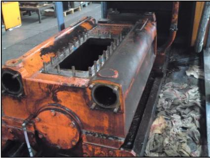
Instalada en el 2000, una UV30, para la producción de latas de aluminio, pertenece a la primera generación de bombas de vacío refrigeradas por aire y de grandes caudales. Trabajando 24/7, esta máquina merece un control total para regresar a trabajar por la próxima década.
