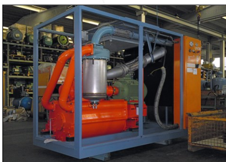
UV30 assemblato, totalmente revisionato, pronto per il collaudo
