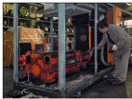
Smontaggio e pulitura dell'UV30
