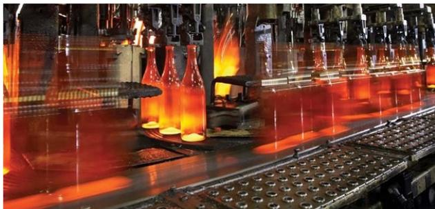
Tradicionalmente Pneumofore abastece a las vidrieras sistemas de vacío centralizados. Según la capacidad del horno, también los compresores de la serie A pueden ser instalados para suministrar aire comprimido requerido durante el proceso de formación de los envases en vidrio.
