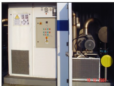
Насос UV16 H с бустерным насосом Рутса
