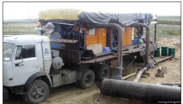
Anhänger mit einer Diesel-Kraftwerkstation und zwei UV50 Pumpen
