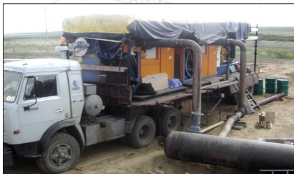
Rimorchio con stazione diesel e pompe UV
