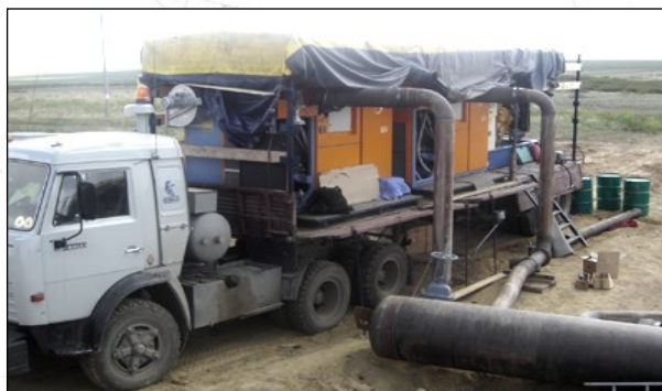
Автоприцеп с дизельной электростанцией и насосами UV
