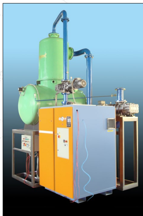
UV8 avec 2 roots : Système de Séchage à vide à 3 étages
