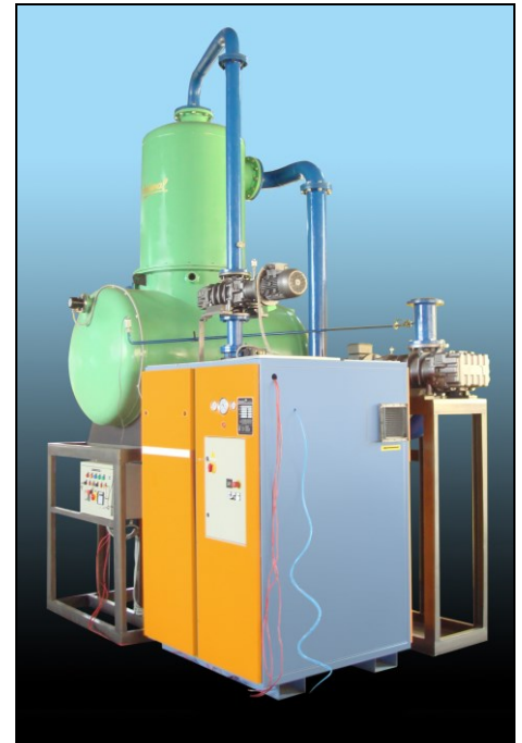
UV8 и 2 насоса Рутса: 3-ступенчатая вакуумная система для сушки
