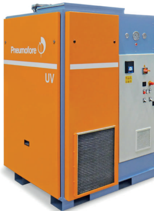
Im Bereich der Lebensmittelverarbeitung erfordert der hohe Feuchtegehalt spezialisierte Vakuumpumpen mit ausgeprägter Wasserresistenz – hier eine dafür optimierte Pumpeninstallation von Pneumofore, Typ UV16 H.
